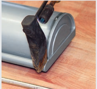
Durchlöten des Endbodens von der Wulst...
