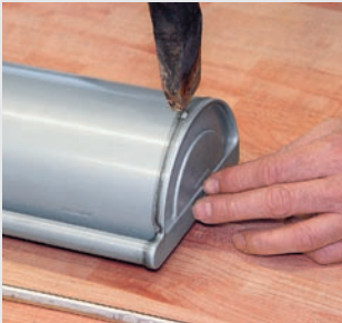
Fixierung des Endbodens mit einer Punktlötstelle.
